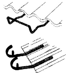
Sicherheitsdachhaken und Einhängvorrichtungen für Dach- bzw. Anlegeleitern
